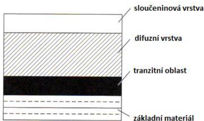
Obr. 3.1-1 – Složení nitridované vrstvy [1, 2]
