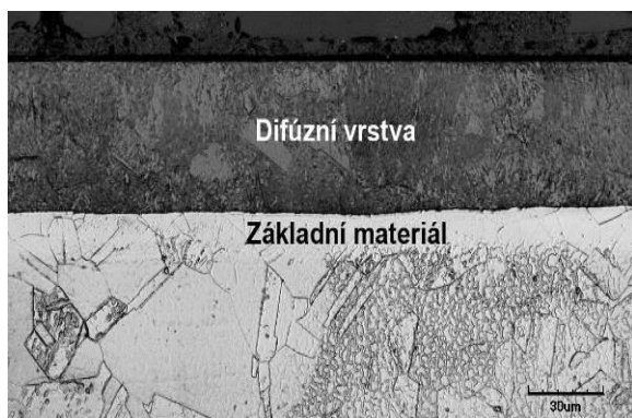
Obr. 3.3.8-6 – Korozivzdorná ocel AISI 302; PN 490 °C/30 h; leptadlo \text{Lučavka} ( \text{HNO}_3 , \text{HCl} 1:3)[53]
