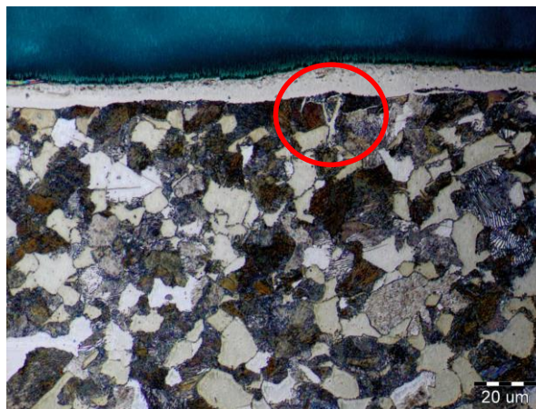
Obr. 4.1.2-4 – Ocel ČSN 41 2050 (C45) v žíháném stavu po karbonitridaci
