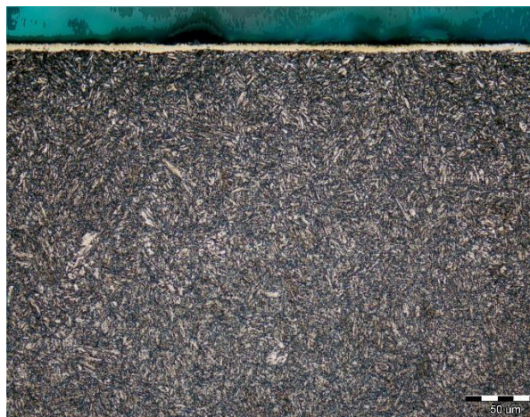
Obr. 4.1.2-2 – Martenzitická struktura vzorku A1 (ČSN 41 2040) s vytvořenou sloučeninovou vrstvou oceli po plazmové nitridaci (PN 500 °C/15 h)
