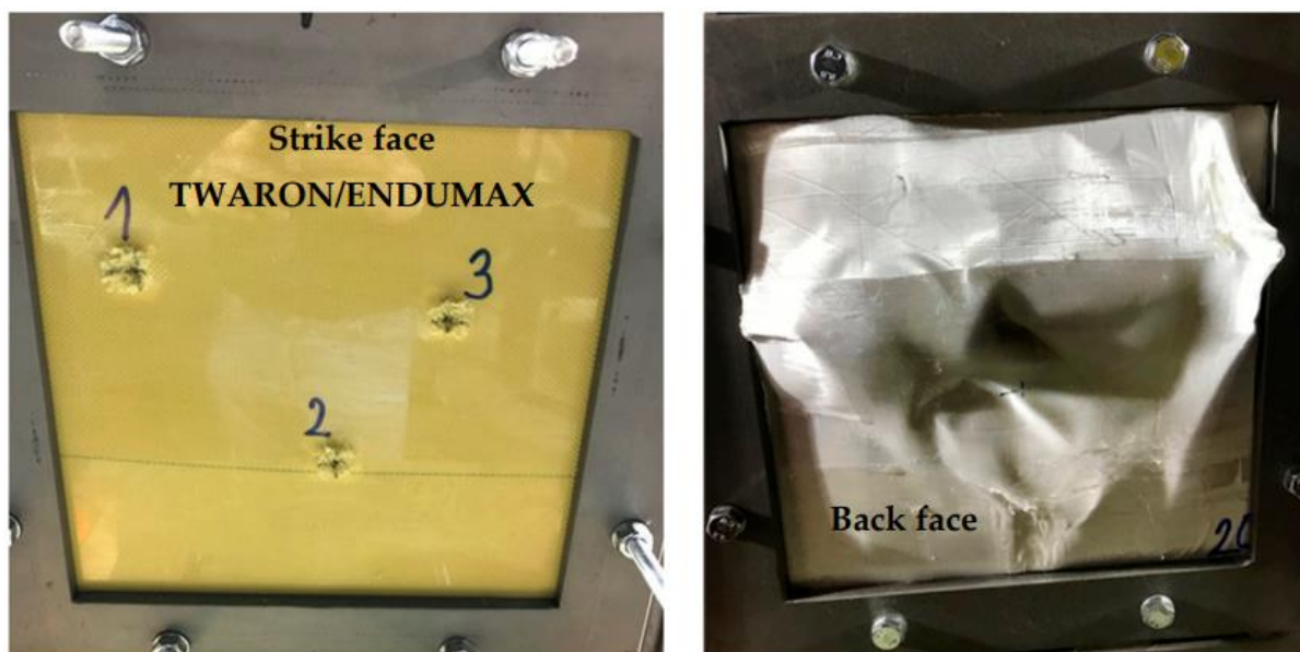
Obr. 4.34 – Hybridní panel Twaron/UMPWPE po balistickém testu
