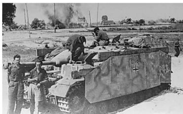
Obr. 2.6 – Představný pancíř na vozidle Stug IV [18]
