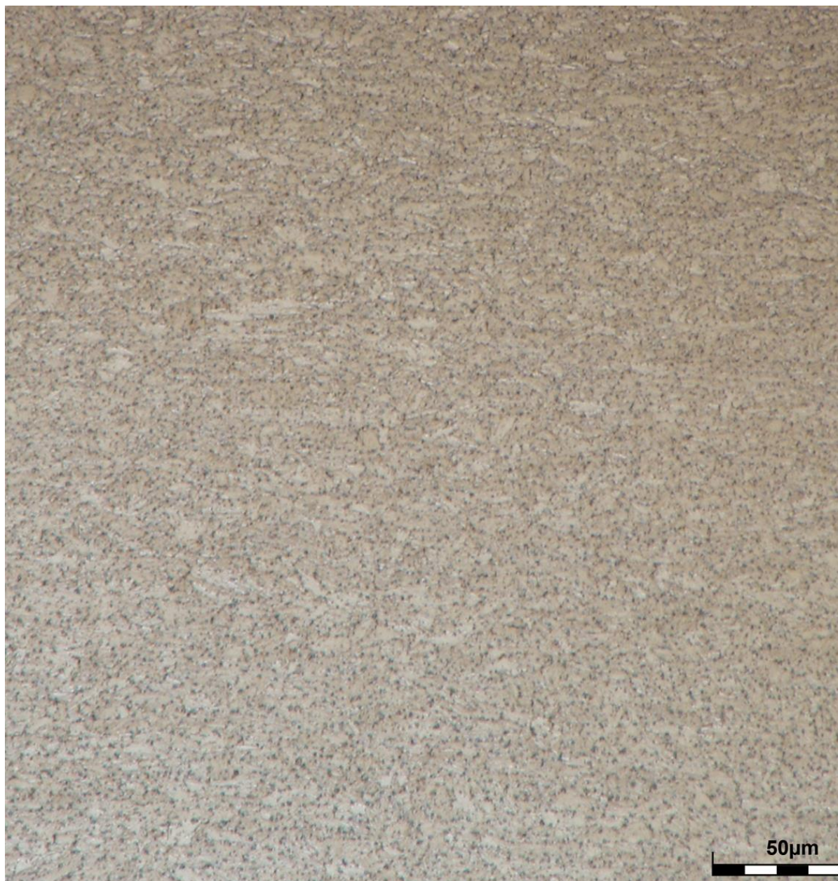
Obr. 4.54 – Struktura pancíře, střední část, zvětšeno 1000x
