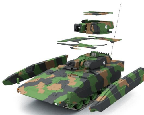
Obr. 4.1 – Přídavná balistická ochrana BVP Puma [9]
