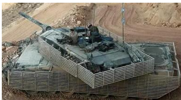
Obr. 4.4 – Využití ochranných mříží SLAT na tanku LEOPARD 2 [9]
