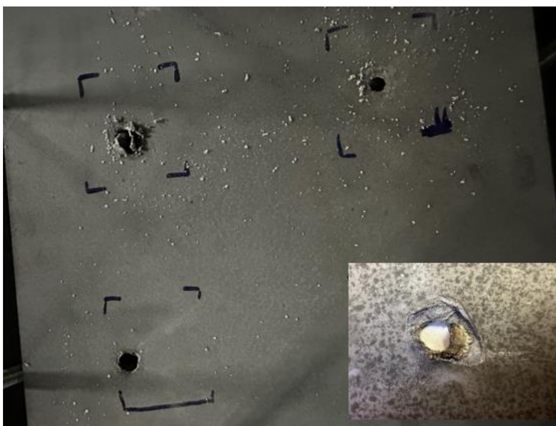
Obr. 5.1 – Průstřel čelní části pancíře HARDOX 450, tl. 2 mm se zobrazením rubové strany
