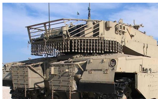
Obr. 4.5 – Použití řetězů na zadní části věže tanku Merkava [9]
