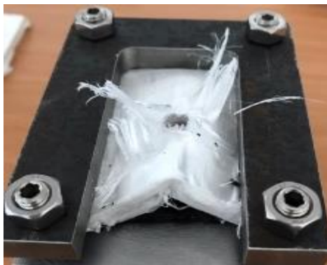
Obr. 4.27 – Prostřelený vzorek Endumax XF23 – 65 vrstev
