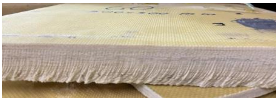
Obr. 4.19 – Vzorek Twaronu 747 po řezání vodním paprskem
