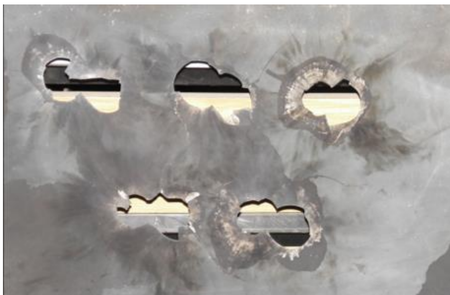
Obr. 4.45 – Zkouška balistické odolnosti opakovanými zásahy na vzdálenost 25 mm (tzv. „multihit“) [117]
