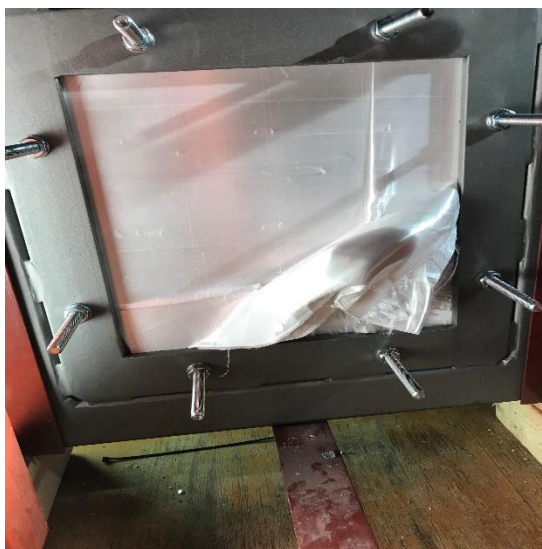
Obr. 4.33 – Záznam projektilu a fragmentů střely pro průchodu desky Twaron CT747/LG700
