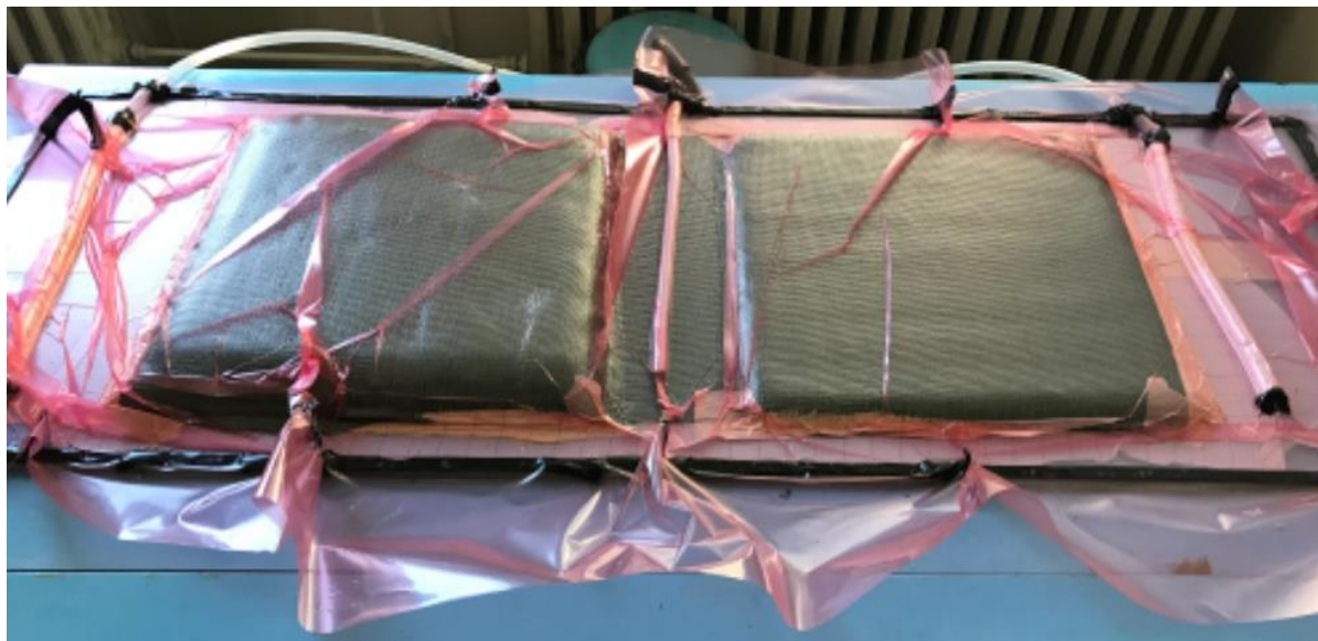
Obr. 4.16 – Materiál připravený k vakuové infuzi (VARTM), ve spolupráci s VUT v Brně
