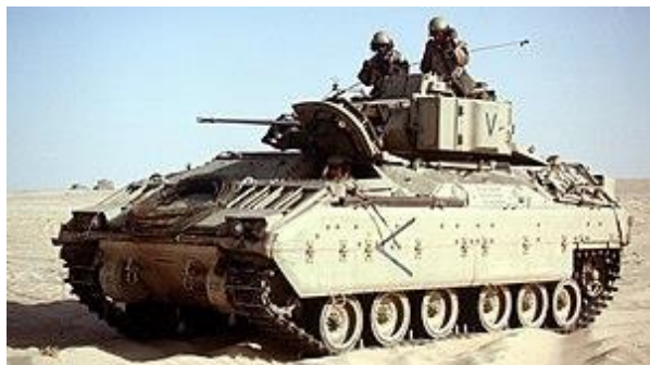
Obr. 4.2 – Představný pancíř vozidla M2A2 Bradley [9]
