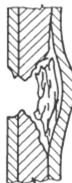
Obr. 4.9 – Poškození vrstveného hliníkového pancíře [35]
