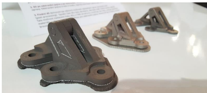
Obr. 4.63 – Příklad použití podpor při tisku Mezi podpory a tištěný model se nanáší keramický separátor (bílá část) pro snazší odstranění podpůrného materiálu. Foto: Protolab VŠB-TUO
