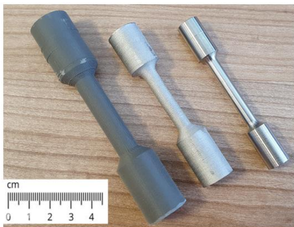
Obr. 4.62 – Výrobní fáze vzorku pro tahovou zkoušku z materiálu BASF Ultrafuse 316L (DIN 1.4404)
