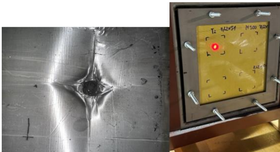
Obr. 5.4 – Vyvinutý vrstvený pancíř včetně zachycené střely
