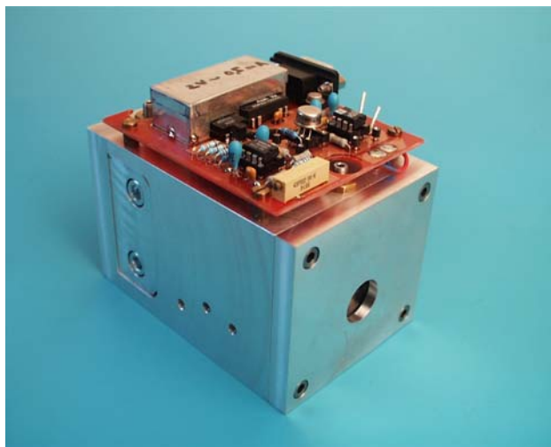
Obr. 3: Kompaktní verze polovodičového laseru s externím rezonátorem
