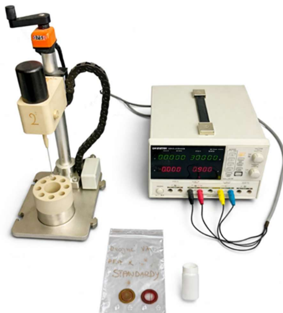
Obr. 1 Sestava elektrodepozičního pracoviště sestává z elektrodepoziční cely, napájecí jednotky stejnosměrného napětí, reakční vialky a nerezových planžet s deponovaným radionuklidem Zdroj: [vlastní fotografie, upraveno autorkou (2026)]
