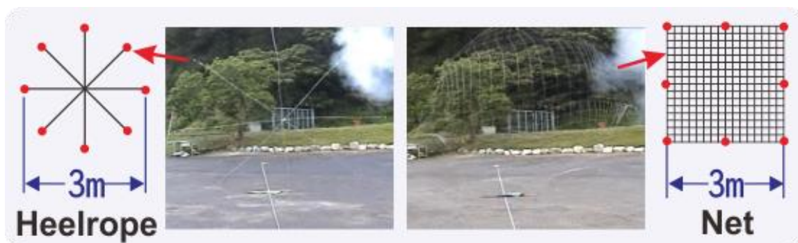
Obr. 5 Druhy vystřelovaných sítí prostředku Super Talon Net Gun. Zdroj: Advanced Weapons Technology [6].
