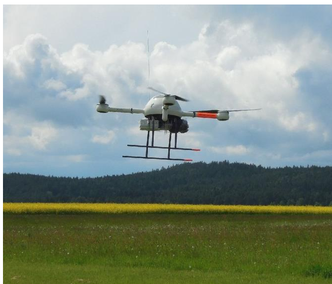
Obr. 3 Bepilotní letoun (kvadrokofter) firmy QRV, model Microdrones md4-1000 (SÚRO, v.v.i.) Zdroj: [7]
