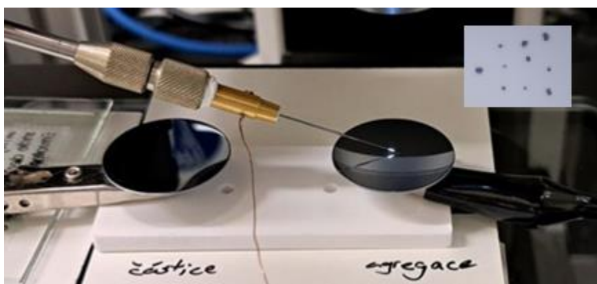
Obrázek 6 Znárodnění přenosu částic mezi dvěma křemíkovými podložkami. Vložený obrázek vpravo nahoře ukazuje výsledné polohy 10 aglomerovaných částic na cílové podložce. Vzdálenosti mezi částicemi jsou ~10 μm.
