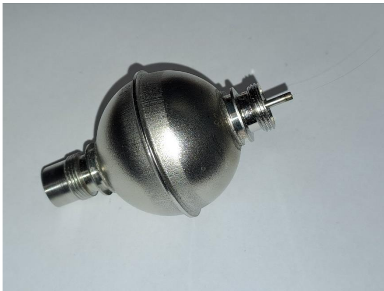
Obrázek 4 Baňka proporcionálního detektoru s nataženým anodovým drátem, připravená k plnění vodíkem
