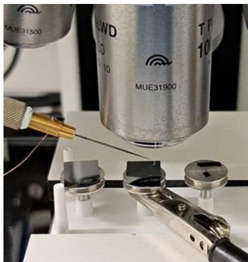
Obrázek 4 Jehla mikromanipulátoru skloněná pod úhlem 20° mezi objektivem 100x optického mikroskopu a povrchem křemíkové podložky s uranovými částicemi.
