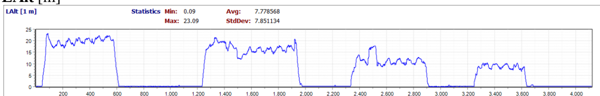
Obrázek 5 Hodnoty lokálního dávkového příkonu ADR_{loc} (v místě detektoru) a ve výšce 1 m nad zemí ADR_{ter 1m} (v 1 m nad zemí) v nGy \cdot h^{-1} a letová výška LAlt v metrech
