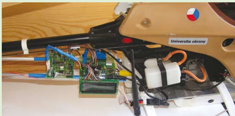
Obr. č. 3 Pohled na pracovní umístění modulů pro přenos obrazu na vrtulníku
