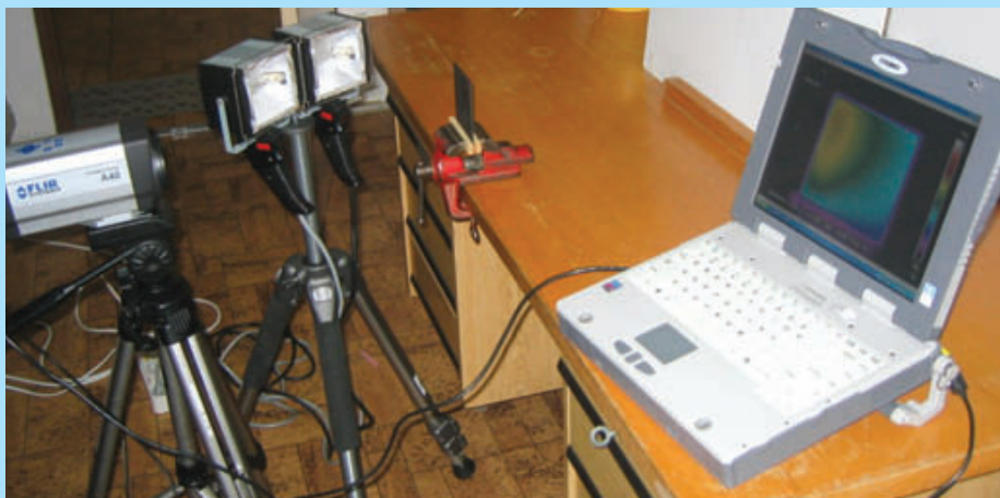
Lokalizace poruchy kompozitového vzorku termografickou metodou
