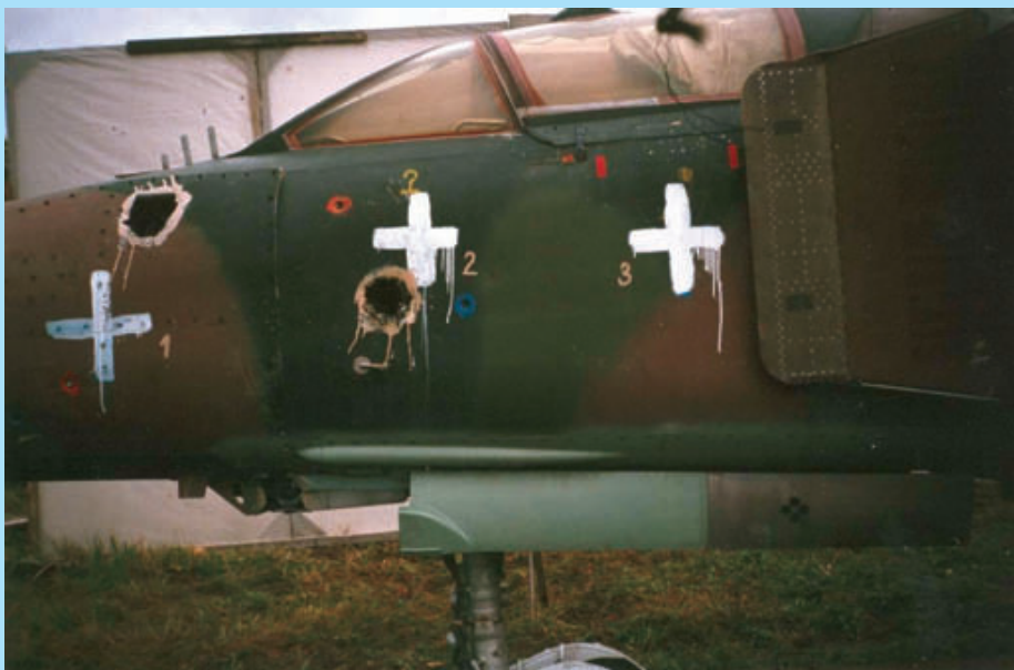
Střelecký experiment s municí ráže 20 mm
