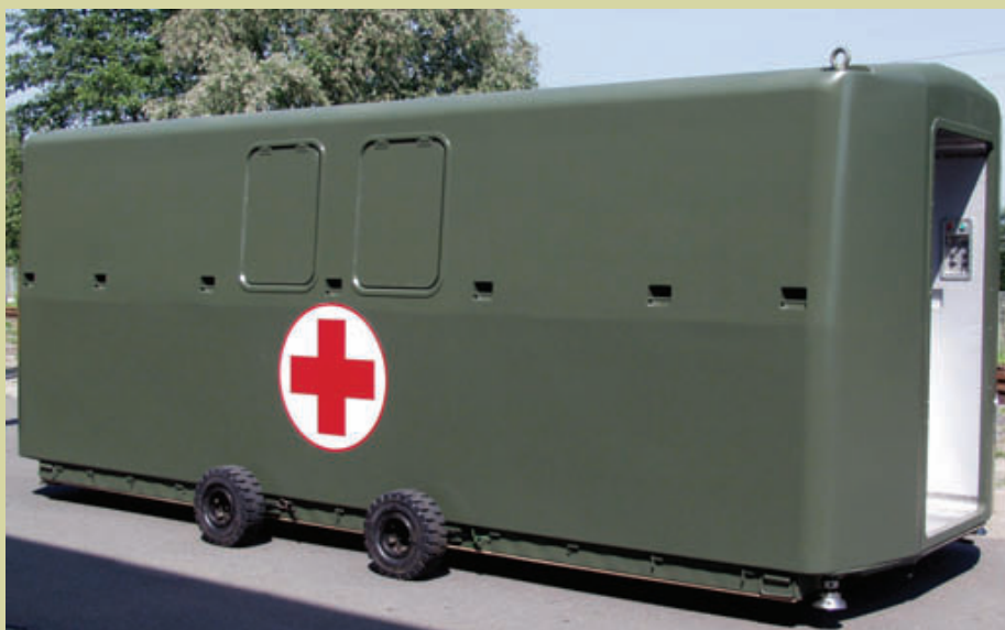
Mobilní buňka polní nemocnice zhotovená z kompozitních materiálů
