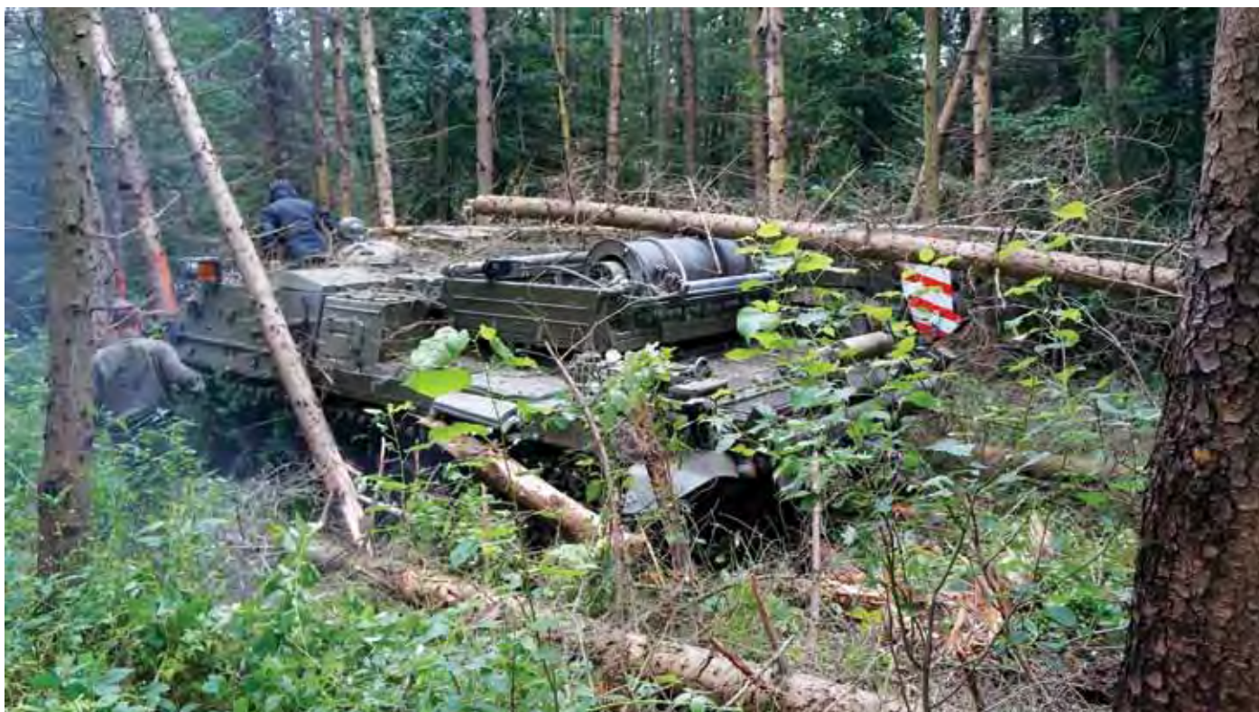
Testy překonávání lesních porostů průrazem stromů těžkou obrněnou technikou
