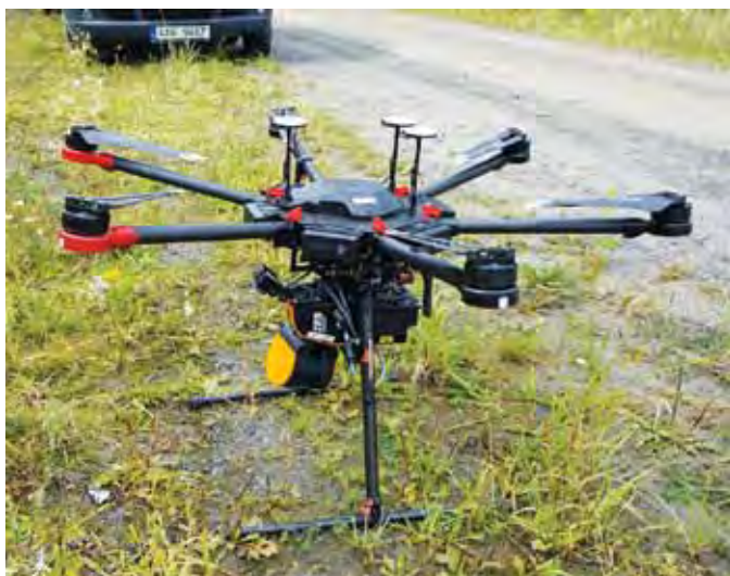
Dron k laserovému mapování struktury lesních porostů
