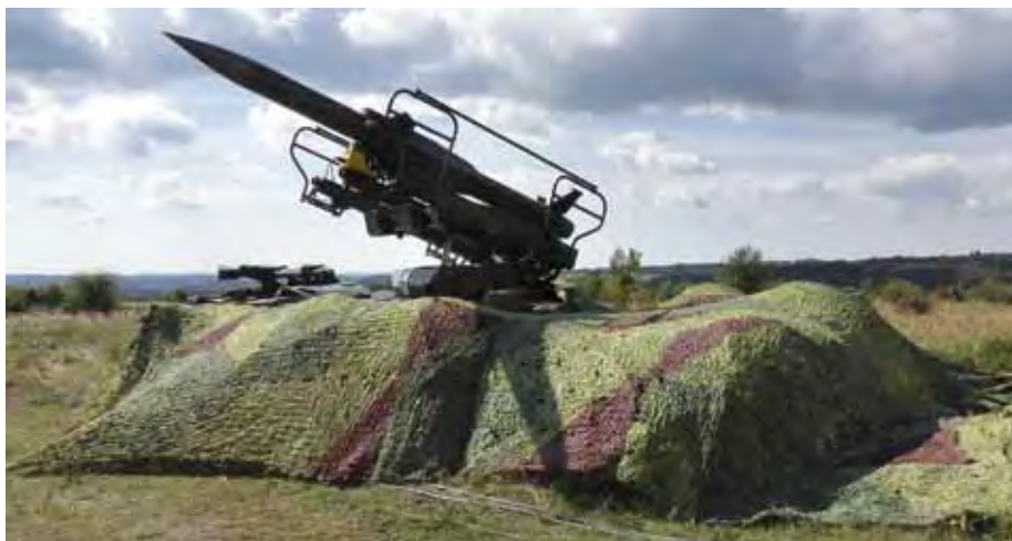
System 2K12 KUB M3 CZ – odpalovací zařízení s imitačním zařízením (žlutě)
