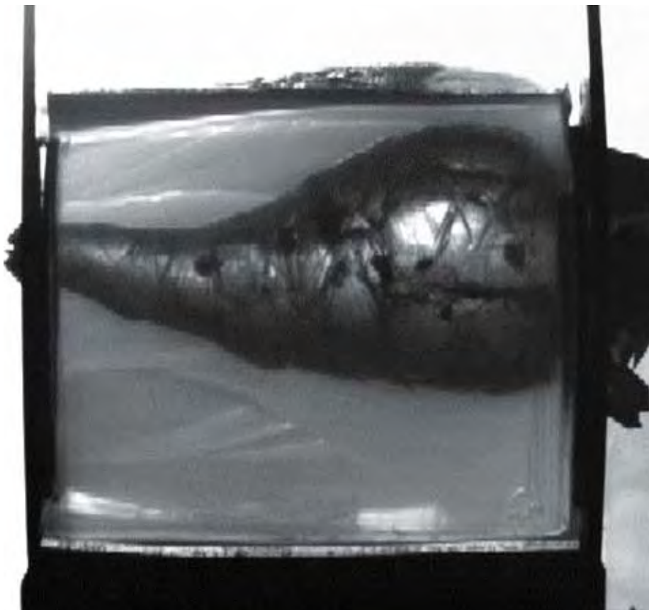
Obr. 4 Průnik střely AM terčem hlava, pohyb střely zprava doleva (ze záznamu vysokorychlostní kamery); celý záznam je možné shlédnout na webových stránkách www.RuceVzhuru.cz
