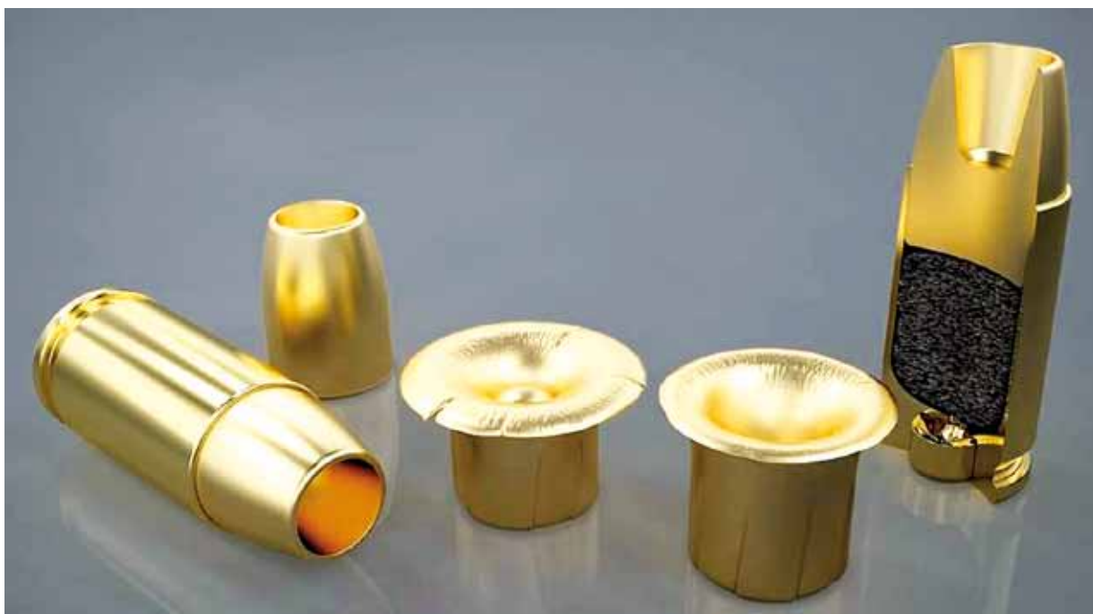
Obr. 1 Náboje 9mm AM – vlevo se střelou, vpravo v řezu, uprostřed dvě expandované střely po průniku etalonovými terči nahrazujícími trup a hlavu člověka.
