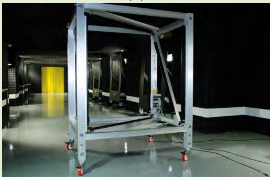
Optoelektronická hradla pro měření rychlosti vystřelených těles
